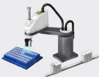
检测断路器触桥是否不良并组装
