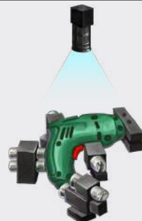
定位电钻 2 个 mark 点，进行多个打螺丝
